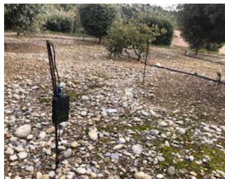
Installation de sondes sur une truffière, vues avec le boîtier de lecture, notez la présence de cailloux relativement petits.
